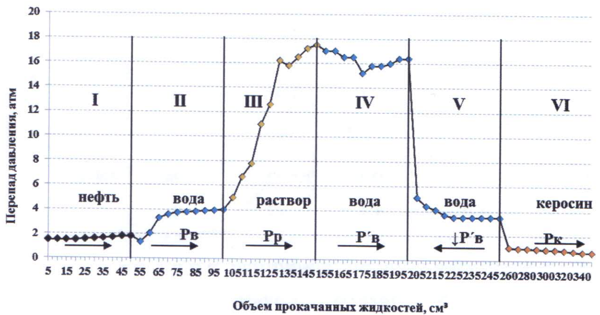
Рисунок 1 – Зависимость перепада давления от объема прокачанных жидкостей через керн (скв./образец №1805/6), проницаемостью по воздуху 0,189 \text{ мкм}^2
